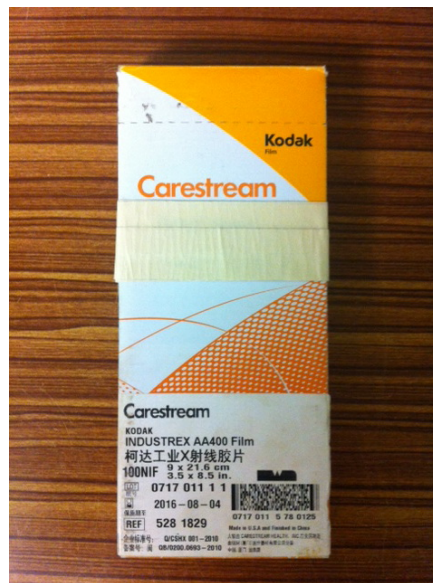
รูปที่ 3.7 ฟิล์มที่ใช้ในการทดลอง ชนิดความไวแสงปานกลาง (Kodak AA400)
