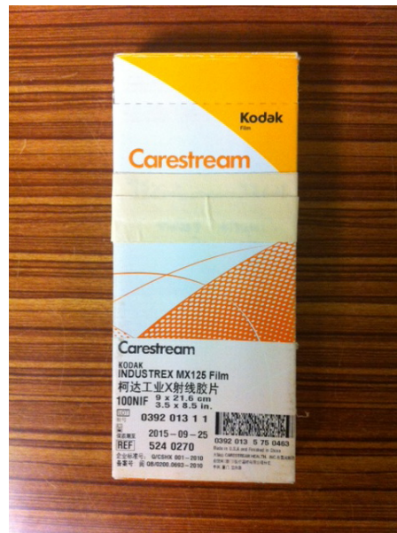
รูปที่ 3.8 फिल्मที่ใช้ในการทดลอง ชนิดความไวแสงปานต่ำ (Kodak MX125)
