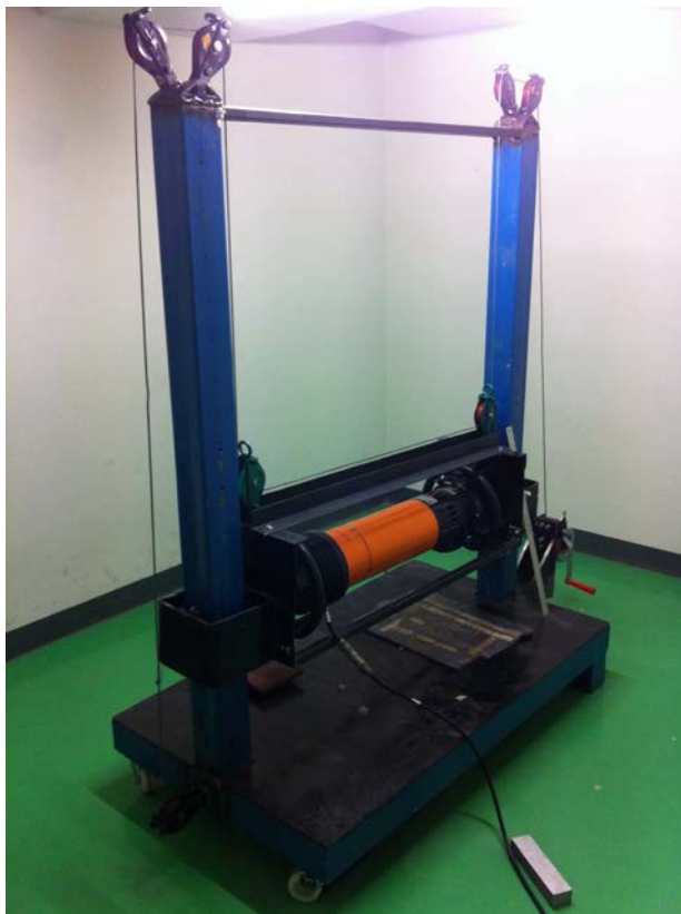
รูปที่ 3.2 เครื่องกำเนิดรังสีเอกซ์ ที่ใช้ในการทดลอง
