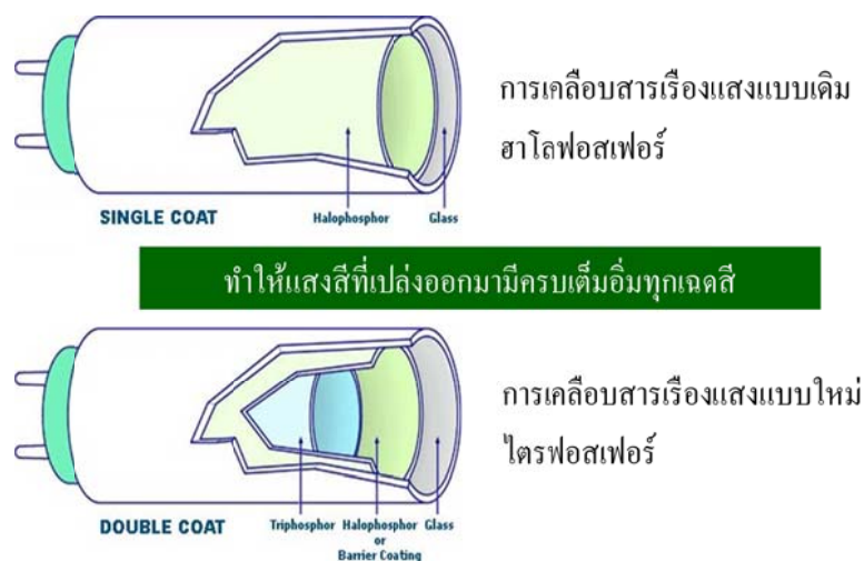
รูปที่ 2.7 แสดงเทคโนโลยีการเคลือบสารเรืองแสงของหลอดฟลูออเรสเซนต์
