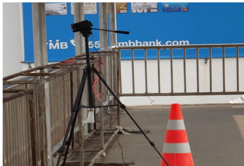
รูปที่ 3.11 รูปแสดง การใช้กล้องวิดีโอเพื่อบันทึกปริมาณจราจรของถนนสายหลัก
