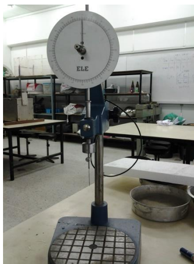
รูปที่ 3.7 เครื่องทดสอบเพนิเทรชัน (Penetration Apparatus)
