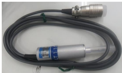
รูปที่ 3.17 LVDT ขนาดความยาวลูกสูบ 10 มม.
