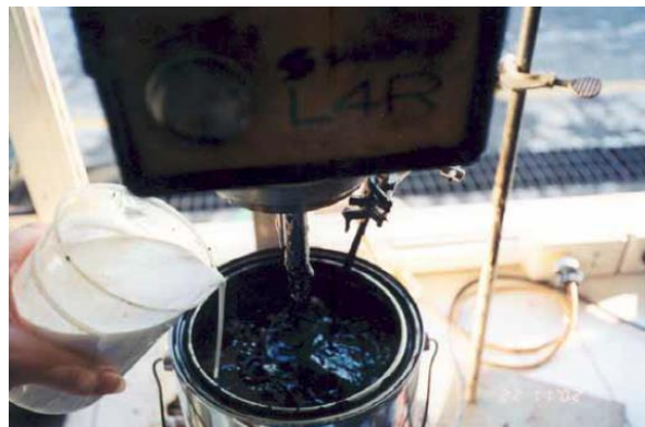
รูปที่ 2.16 การผสมยางพารากับแอสฟัลต์ (ที่มา: Tuntiworawit et al., 2005)
