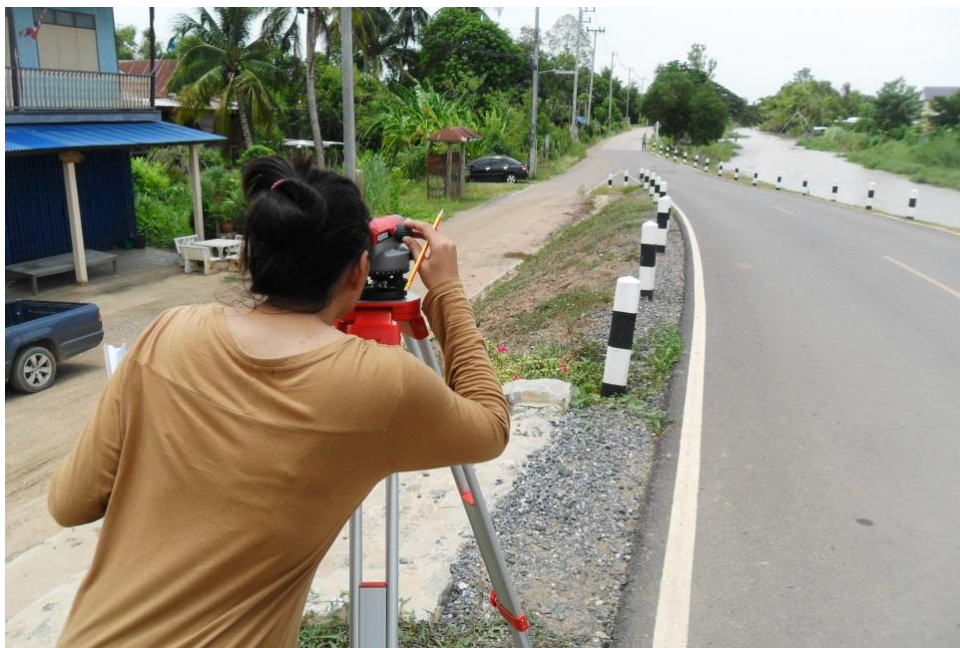
(ค) การเก็บค่าระดับคราบน้ำท่วมในบริเวณช่วงริมตลิ่งฝั่งซ้ายของ ไซฟอนคลองระบายใหญ่ ชัยนาท - ป่าสัก 2
