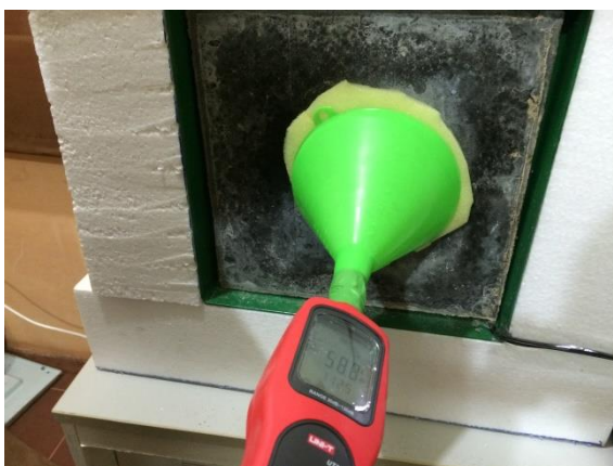
รูปที่ 3.38 การทดสอบประสิทธิภาพการป้องกันเสียงของแผ่นซีเมนต์บอร์ดจากเก้าะลามะพร้าว ด้วยเครื่องวัดระดับเสียง
