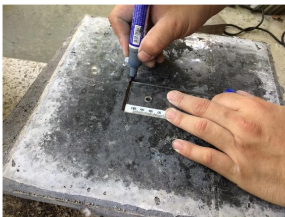
รูปที่ 3.28 การวัดและตัดแผ่นซีเมนต์บอร์ดจากเก้าอี้กลามะพร้าว ให้มีขนาดตามการทดสอบความต้านทานแรงดัดที่ผิวหน้า
