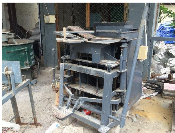
รูปที่ 2 การขึ้นรูปแผ่นซีเมนต์บอร์ดจากเถ้ากะลามะพร้าวด้วยเครื่องอัดแบบสั้นเขย่า
