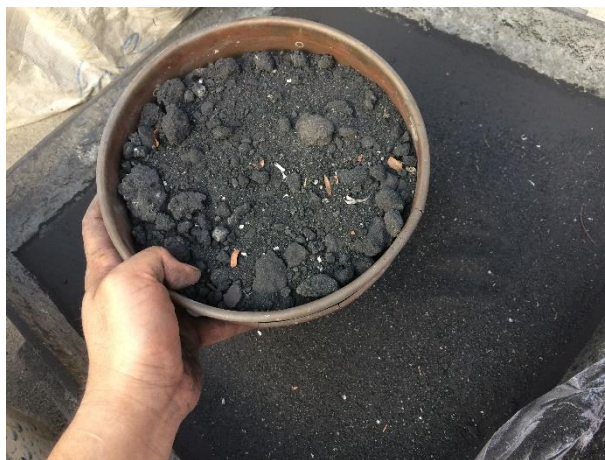
รูปที่ 1 การร้อนเถ้ากะลามะพร้าวผ่านตะแกรงเบอร์ 8 เพื่อคัดขนาด
