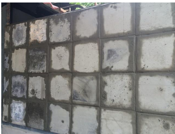
รูปที่ 4.21 ลักษณะผนังจำลองที่ติดตั้งแผ่นซีเมนต์บอร์ดจากถ้ำกะลามะพร้าว
