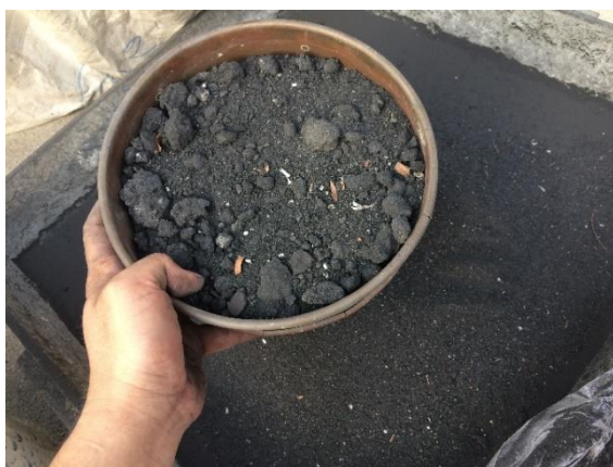
รูปที่ 3.4 การคัดขนาดของเถ้ากะลามะพร้าวโดยการร่อนผ่านตะแกรงเบอร์ 8
