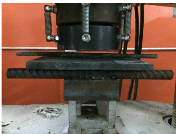
รูปที่ 3.24 การวางจุดรองรับและจุดให้น้ำหนักทดสอบของแผ่นซีเมนต์บอร์ดจากถ้ำกะลามะพร้าว
