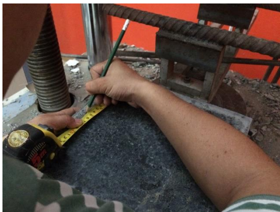
รูปที่ 3.23 การระบุตำแหน่งให้น้ำหนักทดสอบของแผ่นซีเมนต์บอร์ดจากถ้ำกะลามะพร้าว
