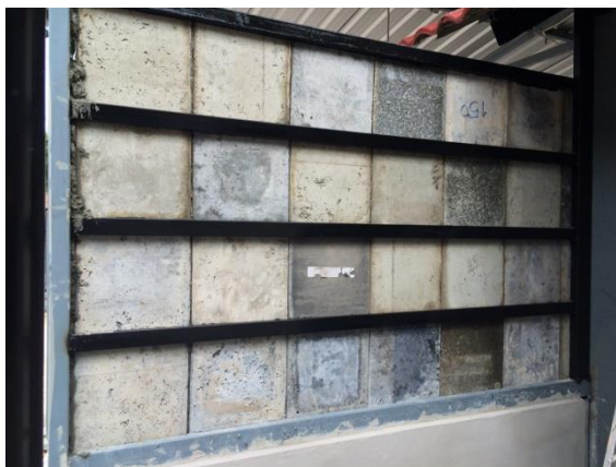
รูปที่ 4.22 ด้านหลังของผนังจำลองที่ติดตั้งแผ่นซีเมนต์บอร์ดจากเก้าอี้ลามาพะพร้าว
