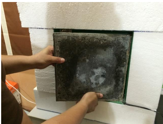
รูปที่ 3.37 การติดตั้งแผ่นซีเมนต์บอร์ดกลาสำหรับทดสอบประสิทธิภาพการป้องกันเสียง
