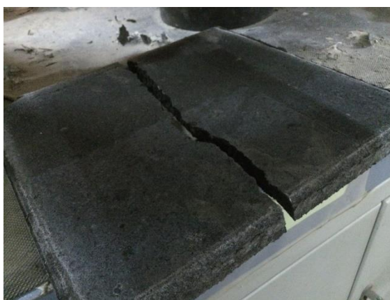
รูปที่ 3.27 การแตกหักของแผ่นซีเมนต์บอร์ดจากเก้าอี้กลามะพร้าว ภายหลังการทดสอบความต้านทานแรงดัดและมอดุลัสยืดหยุ่น
