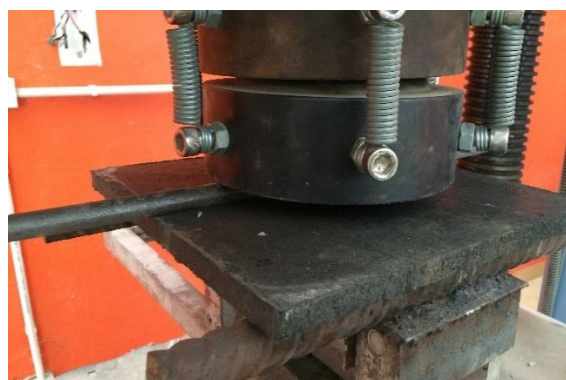
รูปที่ 3.25 การทดสอบความต้านทานแรงดัดและมอดุลัสยืดหยุ่น ของแผ่นซีเมนต์บอร์ดจากถ้ำกะลามะพร้าว
