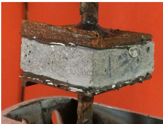
รูปที่ 3.32 การทดสอบความต้านทานแรงดึงที่ผิวหน้าของแผ่นซีเมนต์บอร์ดจากเถ้ากะลามะพร้าว
