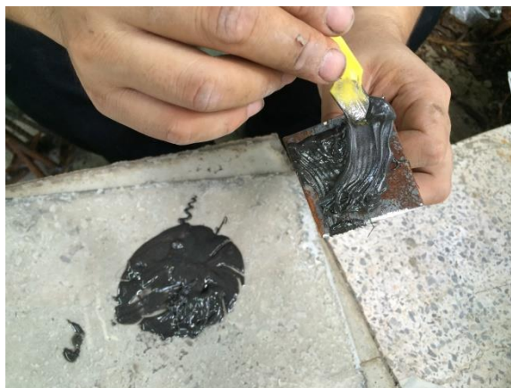
รูปที่ 3.29 การติดแผ่นซีเมนต์บอร์ดจากเถ้ากะลามะพร้าวเข้ากับเหล็กยึดด้วยกาวติดเหล็ก สำหรับทดสอบความต้านทานแรงดึงที่ผิวหน้า
