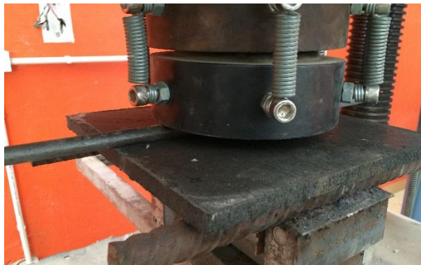
รูปที่ 4 การทดสอบความต้านทานแรงดัดและมอดุลัสยืดหยุ่นของแผ่นซีเมนต์บอร์ดจากเก้าอี้ลามาพร้าว
