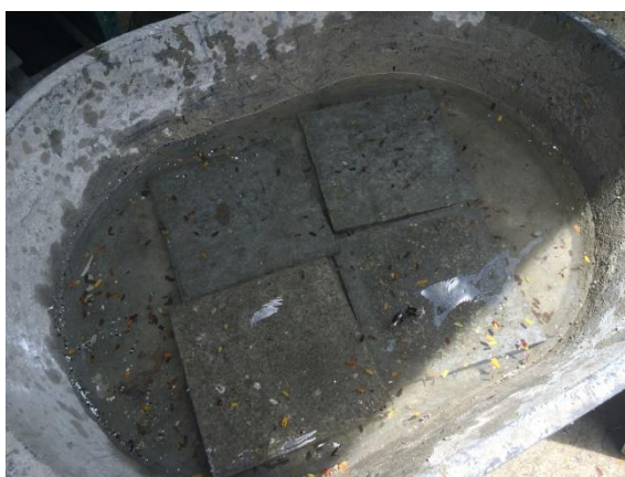
รูปที่ 3.21 การแช่แผ่นซีเมนต์บอร์ดจากเก้าะลามะพร้าวในน้ำเพื่อทดสอบการพองตัว
