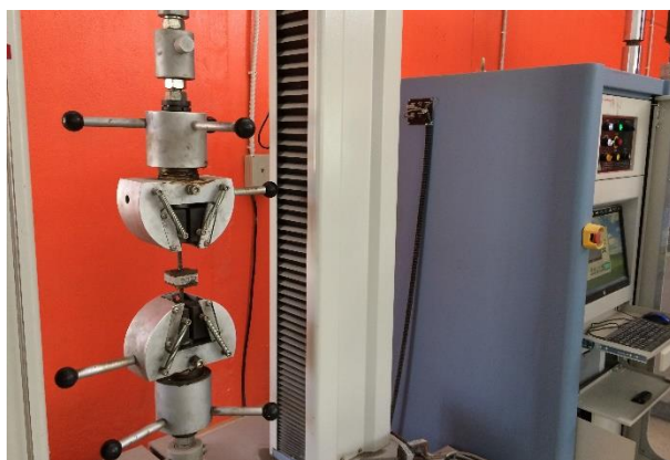
รูปที่ 5 การทดสอบความต้านทานแรงดึงที่ผิวหน้าของแผ่นซีเมนต์บอร์ดจากเก้าอี้ลามาพร้าว
