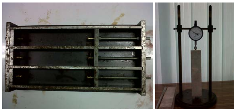
ภาพผนวกที่ ก4 แบบหล่อคอนกรีตไมโครบาร์ และเครื่องเปรียบเทียบความยาว
