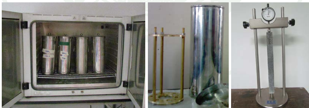
ภาพผนวกที่ ก3 อุปกรณ์การทดสอบด้วยวิธีแรงปฏิกิริยาการขยายตัวของแท่งมอร์ตาร์
