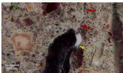
ภาพที่ 13 ตัวอย่างคอนกรีตเจาะแสดงรอยแตกร้าว ที่เกิดจากปฏิกิริยาแอลคาไลซิลิกาจากกรณีศึกษาในประเทศ
