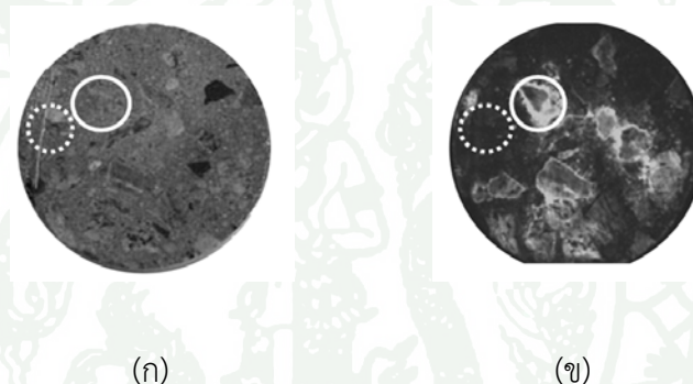
ภาพที่ 25 การสะท้อนแสงของชิ้นตัวอย่างจากโครงสร้างจริงด้วย Uranyl Acetate (ก) ภายใต้แสง ธรรมชาติ และ (ข) ภายใต้แสง UV ในห้องมืด
