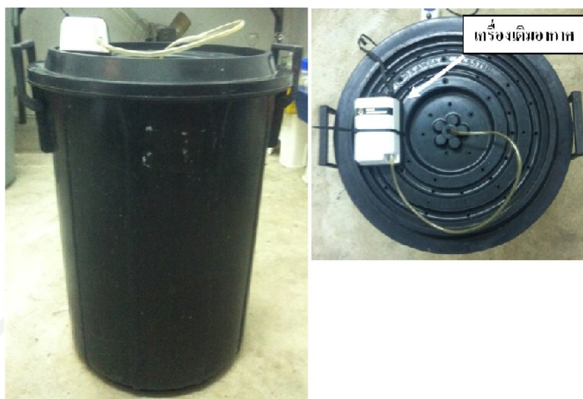
ภาพที่ 31 ลักษณะถังปฏิกรณ์ชีวภาพ และเครื่องเติมอากาศ
