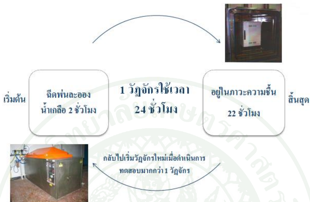
ภาพที่ 7 วัฏจักรทดสอบละอองน้ำเกลือ
