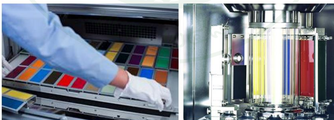
ภาพที่ 13 ชิ้นส่วนตัวอย่างที่ใช้ทดสอบรังสีอัลตราไวโอเลต (UV)
