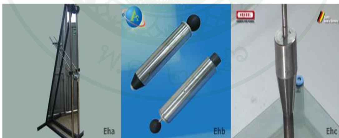
ภาพที่ 18 ค้อนลูกตุ้ม ค้อนสปริง ค้อนแนวตั้ง ตามลำดับ
