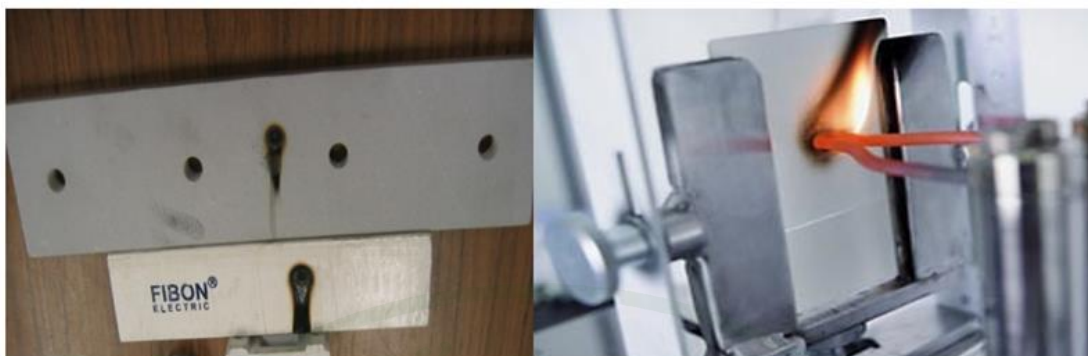
ภาพที่ 12 ตัวอย่างผลหลังการทดสอบและขณะกดลวดร้อนบนชิ้นตัวอย่างทดสอบ
