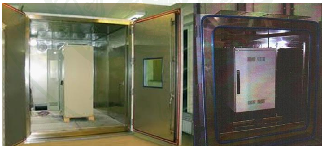
ภาพที่ 1 ห้องทดสอบภาวะร้อนขึ้นของตู้ไฟฟ้าแบบขนาดปกติและตัวแทนที่มีขนาดเล็ก
