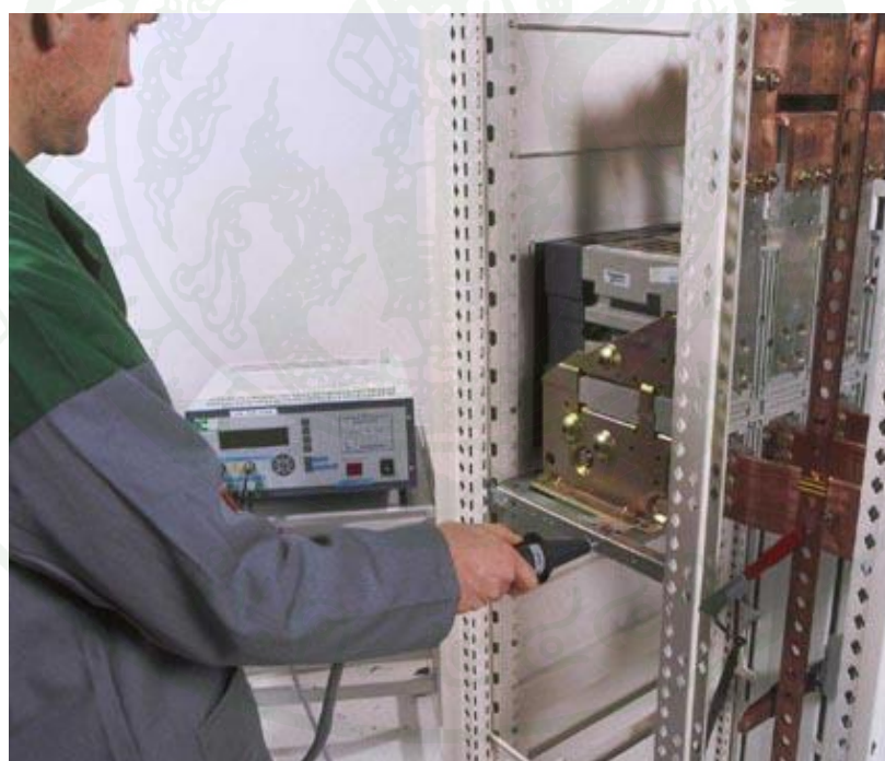
ภาพที่ 67 การวัดความต้านทาน
