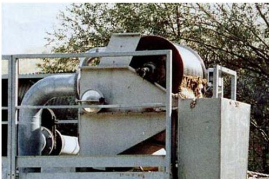
รูปที่ 4.19 ตะแกรงชนิดละเอียดมากแบบกงล้อหมุน [47]
