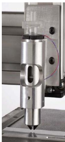
รูปที่ 9 เครื่องพิมพ์แบบ drop-on-demand model PH-41 MicroFab TECHNOLOGIES.Inc ใช้สำหรับพิมพ์หมึกลงบนวัสดุรองรับ สามารถนำมาประยุกต์ใช้พิมพ์หมึกนำไฟฟ้าได้
