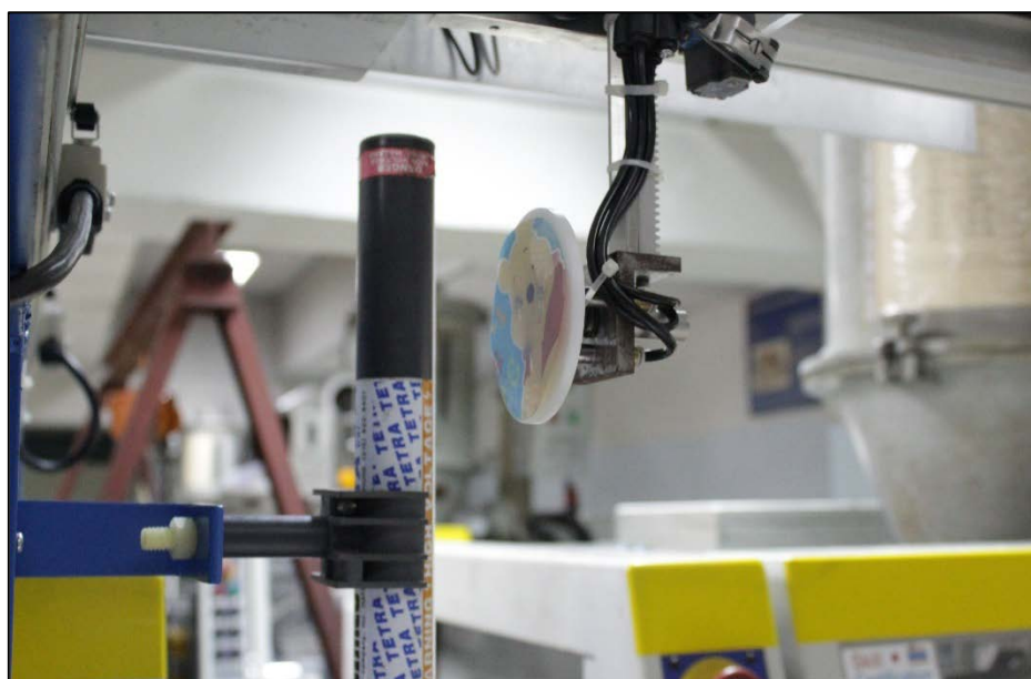
รูปที่ 66 Applicator ขณะจับแผ่นฉลากเคลื่อนผ่าน Charging Bar
