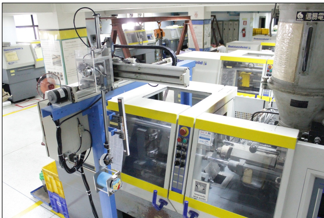
รูปที่ 58 ระบบ Transfer System เมื่อติดตั้งร่วมกับเครื่องฉีดพลาสติก (1)
