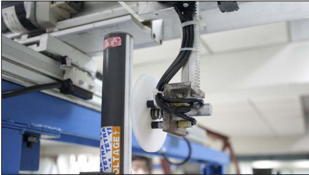
รูปที่ 43 Applicator ที่สร้างภายหลังจากการปรับปรุงแก้ไขขณะเคลื่อนที่ผ่าน Charging Bar
