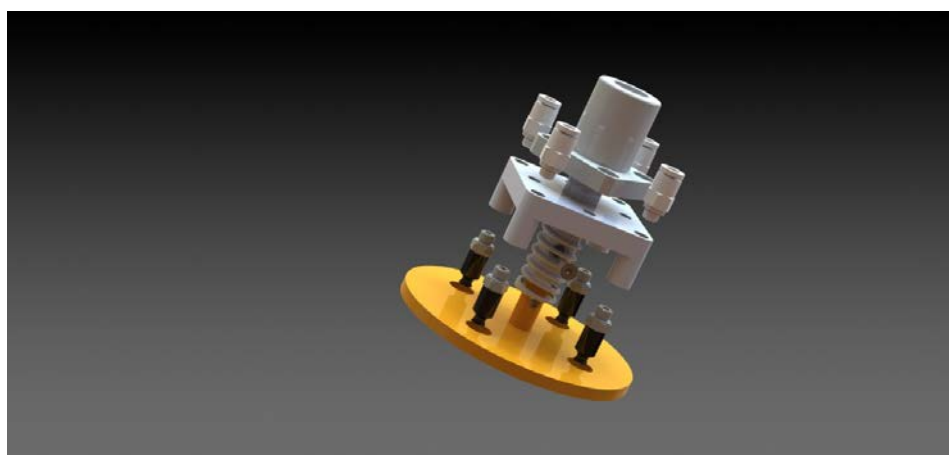
รูปที่ 30 แสดงภาพชิ้นส่วนทั้งหมด และการประกอบชุดจับแผ่นฉลาก
