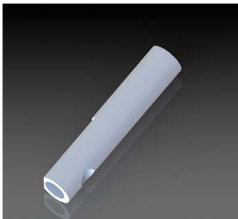
รูปที่ 29 แสดงส่วนประกอบของชุดจับแผ่นฉลาก ใช้สำหรับต่อกับอุปกรณ์ลม โดยทำจาก Steel
