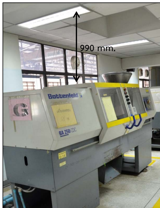
รูปที่ 50 ระยะด้านบนของเครื่องฉีดพลาสติกที่ระบบลำเลียงสามารถทำงานได้
