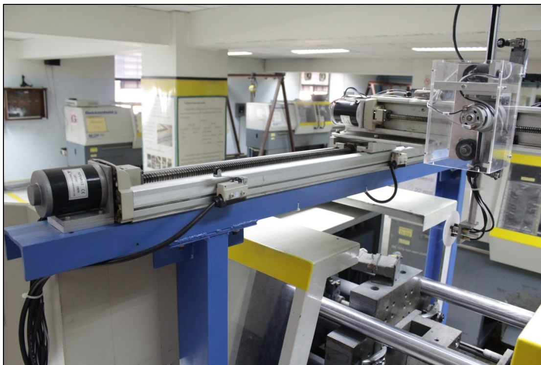
รูปที่ 59 ระบบ Transfer System เมื่อติดตั้งร่วมกับเครื่องฉีดพลาสติก(2)
