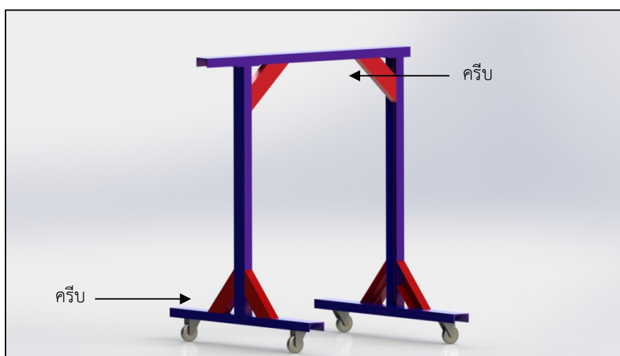
รูปที่ 70 การติดตั้งครีปเสริมความแข็งแรง (บริเวณสีแดง)
