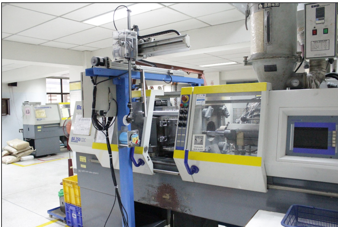
รูปที่ 61 ระบบ Transfer System เมื่อติดตั้งร่วมกับเครื่องฉีดพลาสติก(4)
