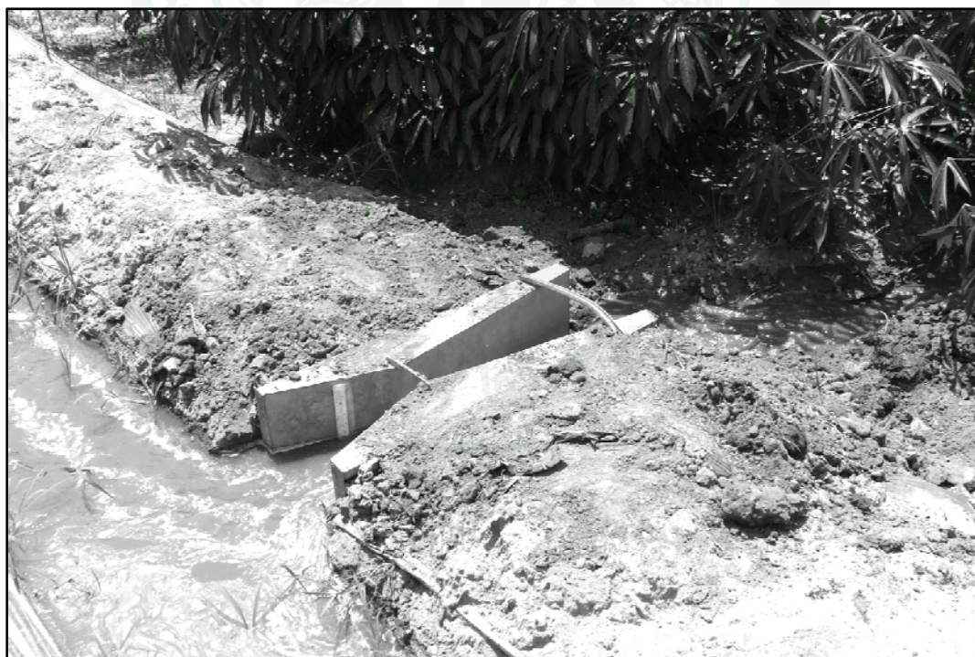
ภาพที่ 8 ตำแหน่ง cut throat flume ขนาด 10 \times 90 ซม. หน้าแปลงทดลอง T_1R_1 , T_1R_2 และ T_1R_3
