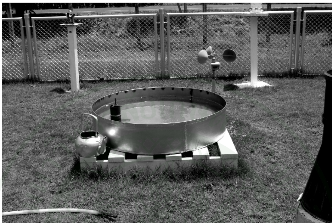
ภาพผนวกที่ 8 ถาดวัดการระเหยแบบ U.S. Class A pan และที่วัดความเร็วลม (Wind Speed Measurement)
