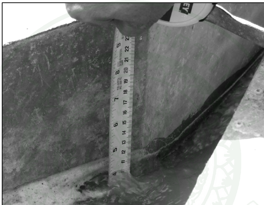
ภาพที่ 9 การวัดระดับน้ำ cut throat flume ขนาด 10 \times 90 ซม. เมื่อระดับน้ำเริ่มคงที่
