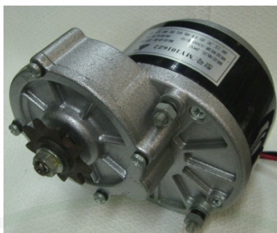
ภาพที่ 7 มอเตอร์กระแสตรงขนาด 250 watt 24volt
