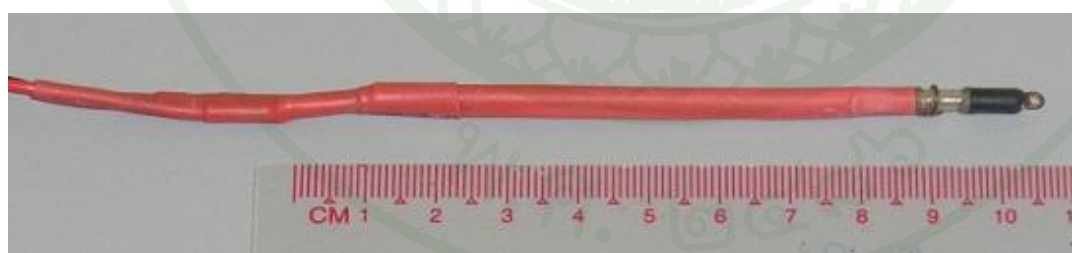
ภาพที่ 9 ลักษณะโพรบที่ใช้รีดน้ำเชื้อในนกแก๊ก
