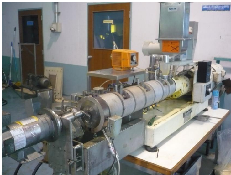
ภาพผนวกที่ ก1 เครื่องเอกซ์ทรูเดอร์แบบสกรูคู่ รุ่น Herman Berstoff Laboratory, ZE 25x33D
