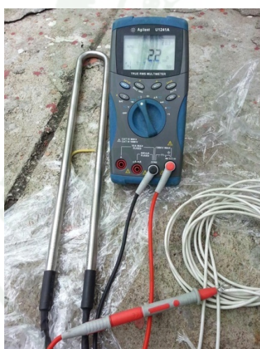
ภาพที่ 29 Load ที่ออกแบบไว้สำหรับทดลองค่าการดึงกระแสไฟฟ้า
