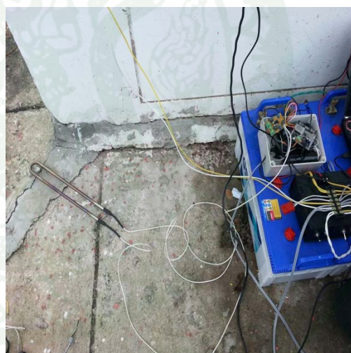
ภาพที่ 29 Load ที่ออกแบบไว้สำหรับทดลองค่าการดึงกระแสไฟฟ้า
