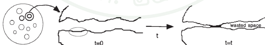
ภาพที่ 3 การเสื่อมสภาพของตัวเร่งปฏิกิริยาที่เกิดจากการเผาผนึกแบบปิดรูพรุน
