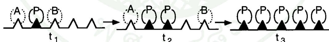
ภาพที่ 1 การเสื่อมสภาพของตัวเร่งปฏิกิริยาที่เกิดจาก Poisoning (Fogler, 2006)
