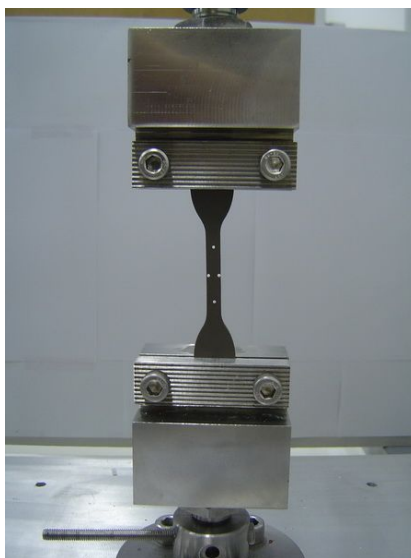
ภาพที่ 3.20 การติดตั้งตัวอย่างวัสดุเพื่อเตรียมการทดสอบ
