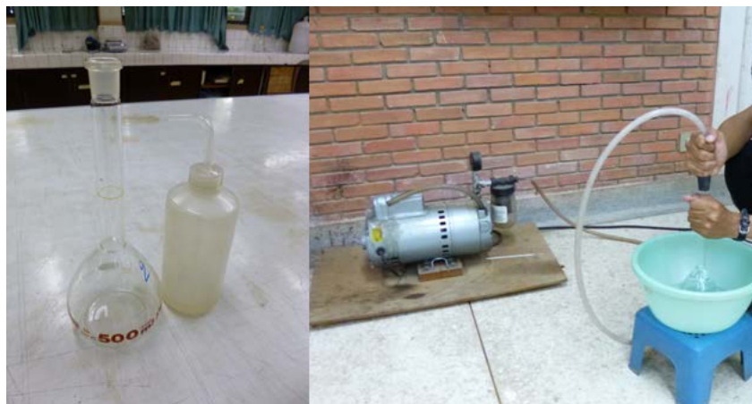
รูปที่ 3.2 แสดงชุดการทดสอบความหนาแน่นจำเพาะ (ขวดวัดปริมาตร 500 ml, กระบอกจืดน้ำ, บั้มดูดอากาศ ตามลำดับ)
