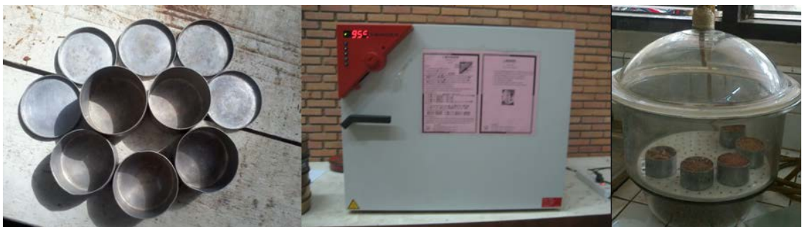
รูปที่ 3.1 แสดงชุดการทดสอบค่าความชื้น (กระป๋องใส่ตัวอย่าง, ตู้อบ, โถดูดความชื้น ตามลำดับ)
