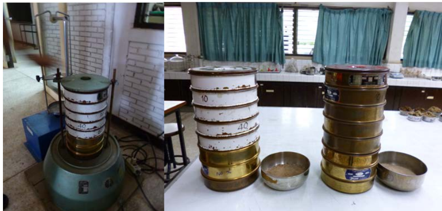
รูปที่ 3.4 แสดงชุดการทดสอบการวิเคราะห์ขนาดเม็ดตะกอน (ตะแกรงร่อน เบอร์ 4, 10, 20, 40, 60, 100 และ 200, เครื่องเขย่าร่อนอัตโนมัติ ตามลำดับ)
