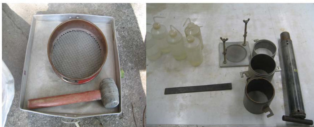
รูปที่ 3.5 แสดงชุดการทดสอบการทดสอบการบดอัดมาตรฐาน (ถาดใส่ดิน, ค้อนยาง, ตะแกรงร่อน เบอร์ 4, กระบอกฉีกรน้ำ, ชุดการทดสอบการบดอัดมาตรฐาน ตามลำดับ)
