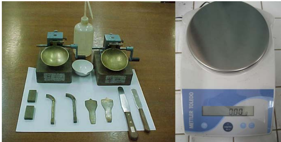
รูปที่ 3.3 แสดงชุดการทดสอบคุณสมบัติด้านพลาสติก (ชุดทดสอบคุณสมบัติด้านพลาสติก เครื่องชั่งน้ำหนัก)
