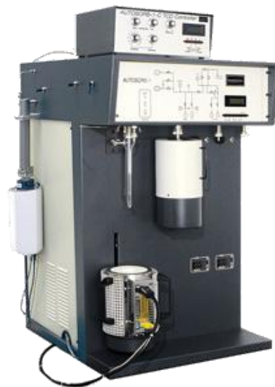
ภาพที่ 4ก เครื่องวิเคราะห์พื้นที่ผิวด้วยก๊าซไนโตรเจน รุ่น Autosorb 1C ที่มา : Quantachrome Chemisorption, 2553
