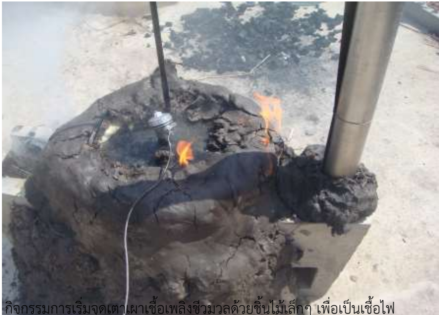
ภาพที่ 1 กิจกรรมการประกอบติดตั้งเครื่องปฏิกรณ์กับเตาเผาเชื้อเพลิงชีวมวล
