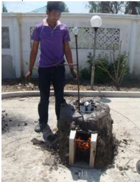
ภาพที่ 2 กิจกรรมการเริ่มจุดเตาเผาเชื้อเพลิงชีวมวลด้วยชิ้นไม้เล็กๆ เพื่อเป็นเชื้อไฟ
