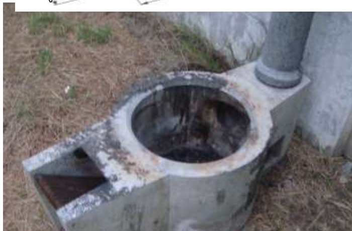
ภาพที่ 4.1 แสดงแบบรูปทรงและขนาดของเตาเผาเชื้อเพลิงชีวมวล แบบเตาแกลบของท้องถิ่นหนองจอก ที่ผู้วิจัยคัดเลือกใช้ในการวิจัย
