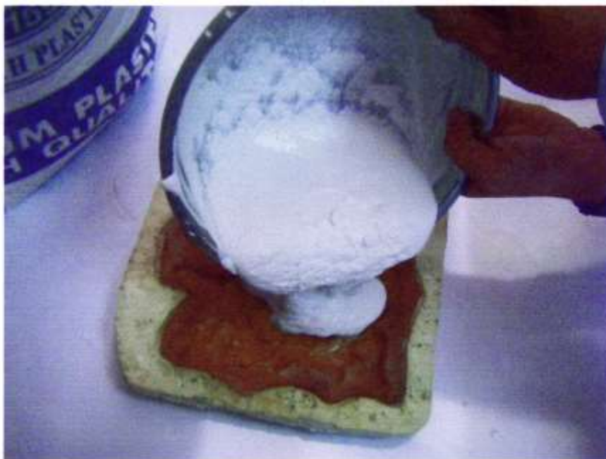
ภาพที่ 4 ปูนพลาสติกเข้ากันดีแล้วเทลงในแม่แบบพิมพ์ ที่มา : ถ่ายในห้องปฏิบัติการ
