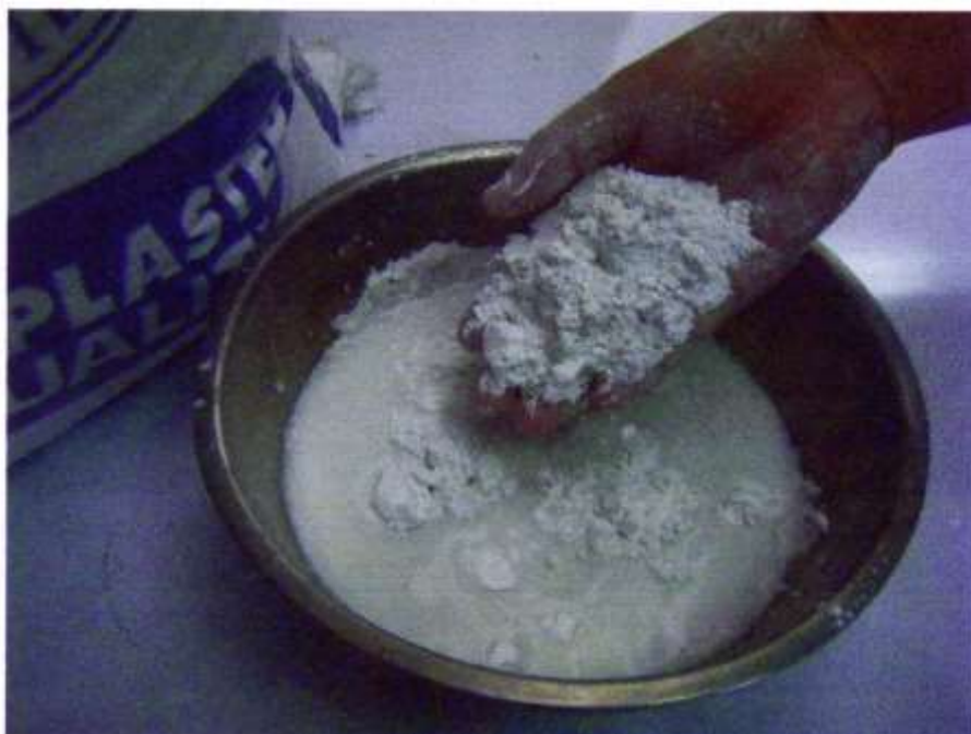
ภาพที่ 4 โรยปูนให้มีปริมาณพอดีกับน้ำ จะได้เนื้อปูนอ่อนชุ่มชื้นพอดี ที่มา : ถ่ายในห้องปฏิบัติการงาน
