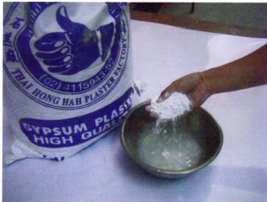
ภาพที่ 3 โรยปูนปลาสเตอร์ลงในภาชนะผสมปูน ที่มา : ถ่ายในห้องปฏิบัติงาน
