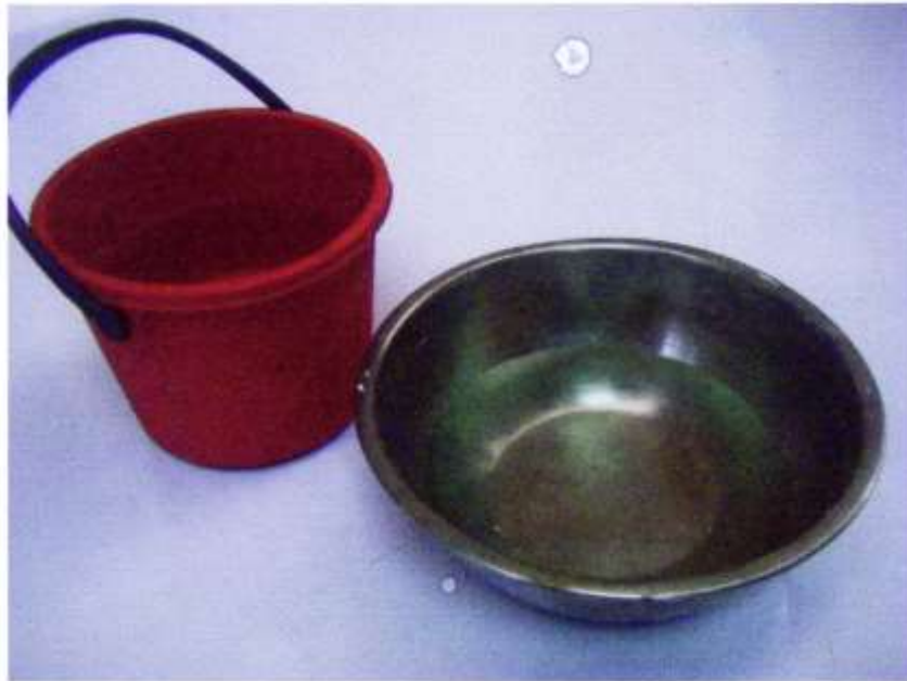
ภาพที่ 2 ใส่น้ำในภาชนะผสมปูนปลาสเตอร์ 1 ใน 3 ส่วน ที่มา : ถ่ายในห้องปฏิบัติงาน
