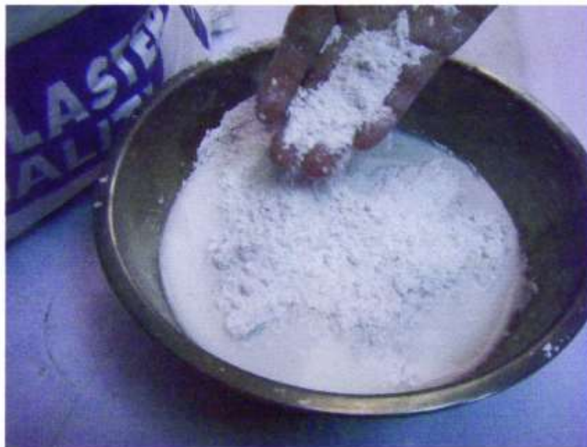
ภาพที่ 5 โรยปูนให้มีปริมาณเหนือน้ำสักเล็กน้อย จะได้เนื้อปูนแข็งชุ่มชื้นมาก ที่มา : ถ่ายในห้องปฏิบัติการงาน
