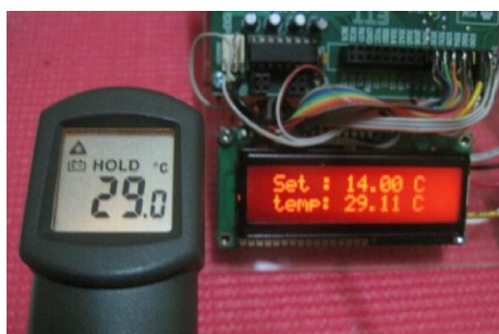
รูปที่ 3.21 การทดสอบหน่วยแสดงผลและควบคุมอุณหภูมิเทียบกับเครื่องมือวัดแบบอินฟาเรด
