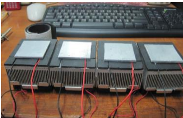
รูปที่ 3.14 ภาพหน่วยกำเนิดความเย็นด้วยเพลเทียร์จำนวน 4 ชุด
