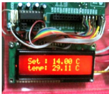
รูปที่ 3.18 ชุดแสดงผลและควบคุมอุณหภูมิที่ยังไม่ได้บรรจุลงกล่อง
