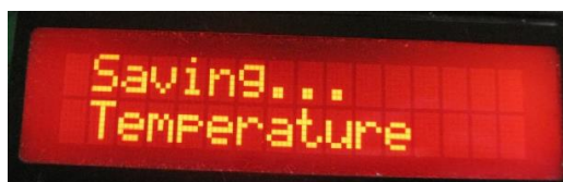
รูปที่ 3.23 จอแอลซีดีแสดงผลเมื่อทำการตั้งค่าอุณหภูมิเสร็จสิ้น
