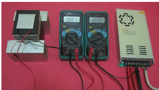
รูปที่ 3.24 การต่อวงจรเพื่อทดสอบประสิทธิภาพของชุดกำเนิดความเย็นด้วยเพลเทียร์
