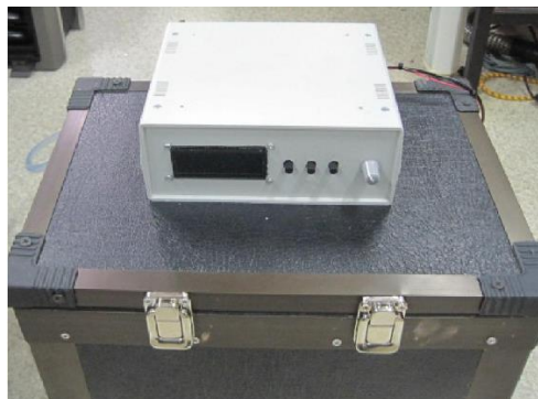
รูปที่ 3.20 กล่องเย็นสำหรับเก็บน้ำนมแม่ด้วยวัสดุฉนวนกันความร้อนแบบแซนวิชรังผึ้งที่ประกอบชุดควบคุมและแสดงผลอุณหภูมิ
