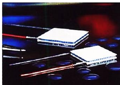
รูปที่ 2.6 รูปร่างของเพลเทียร์ที่ใช้กันทั่วไป [5]
