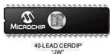
รูปที่ 2.13 ไมโครคอนโทรลเลอร์แบบ EPROM Program memory [15]
