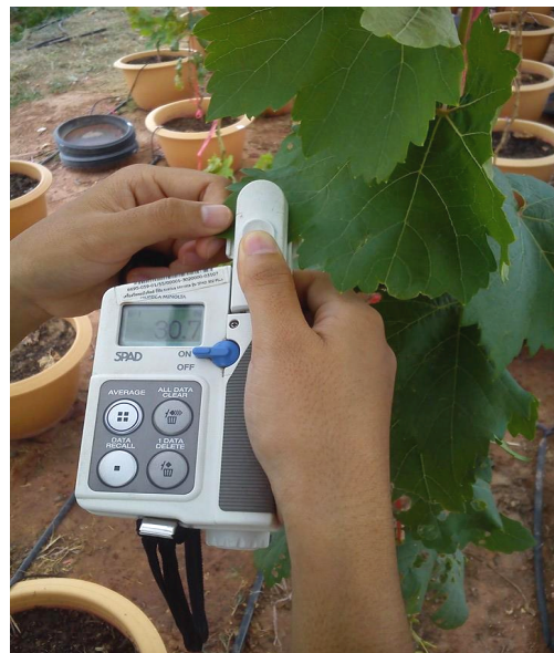
รูปภาพผนวกที่ 2 การวัดปริมาณคลอโรฟิลล์ในใบองุ่น ด้วยเครื่องวัดคลอโรฟิลล์ Konica Minolta รุ่น SPAD 502 plus
