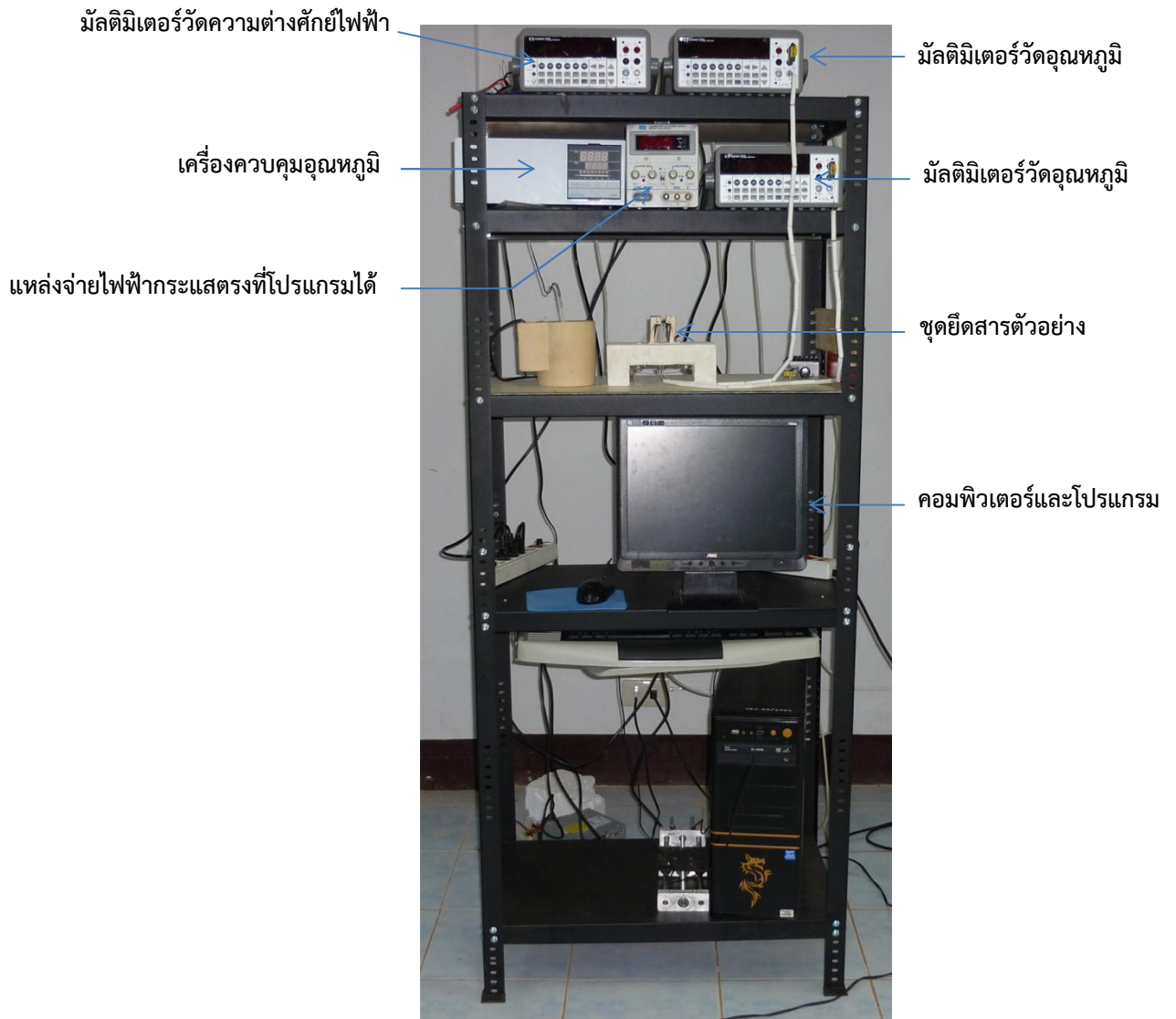
ภาพที่ 4.1 เครื่องวัดค่าสัมประสิทธิ์ซีเบกและสภาพนำไฟฟ้าของวัสดุเทอร์โมอิเล็กทริกที่สร้างขึ้น
