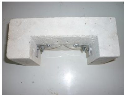
ภาพที่ 3.4 ส่วนฐานของอุปกรณ์ยึดตัวอย่างขนาด 2 \times 3 \times 10 \text{ cm}^3
