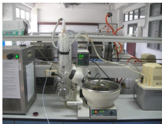
ภาพที่ ก.5 (ก) น้ำส้มควันไม้ที่ตั้งทิ้งไว้ 90 วัน จะเกิดการแยกชั้น (ข) การกลั่นน้ำส้มควันไม้ด้วยเครื่องกลั่นลดความดัน
