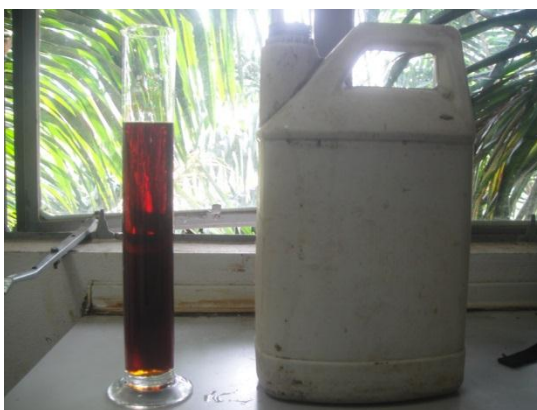
ภาพที่ ก.5 (ก) น้ำส้มควันไม้ที่ตั้งทิ้งไว้ 90 วัน จะเกิดการแยกชั้น (ข) การกลั่นน้ำส้มควันไม้ด้วยเครื่องกลั่นลดความดัน
