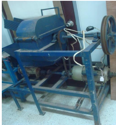
ภาพที่ 3.2 เครื่องย่อยวัชพืชที่ใช้ในการบดเปลือกเมล็ดยางพารา
