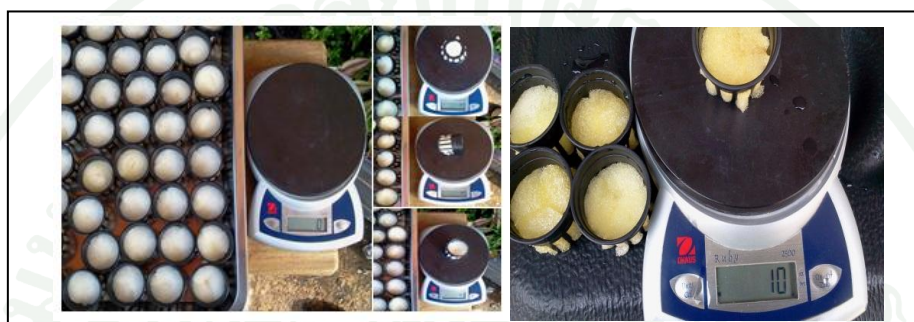
ภาพที่ 30 การชั่งน้ำหนักฟองน้ำก่อน และหลังการทดสอบ
