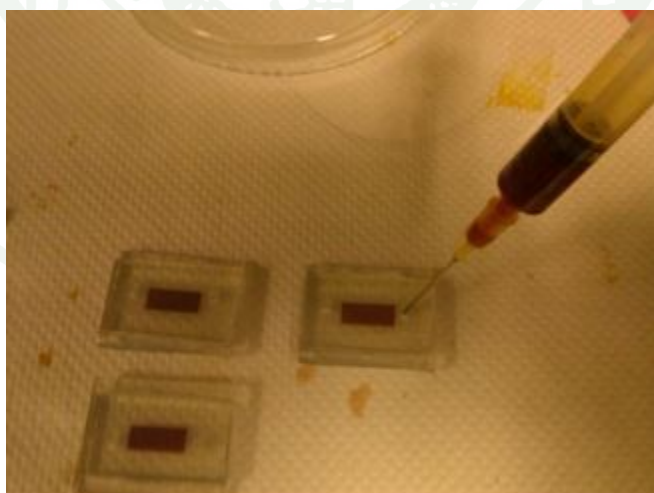
ภาพที่ 33 การเติมสารละลายอิเล็กโทรไลต์
