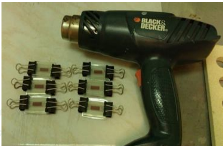
ภาพที่ 32 การใช้คลิปหนีบด้านข้างของเซลล์
