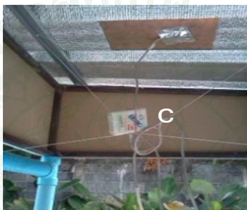
ภาพที่ 34 ตำแหน่งอุปกรณ์ตรวจวัด(c) อุณหภูมิอากาศระยะห่างจากหลังคา 0.30 เมตร
