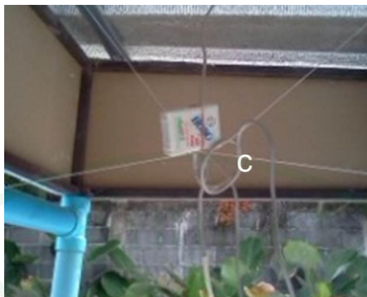
ภาพที่ 38 ตำแหน่งอุปกรณ์ตรวจวัด (c) อุณหภูมิอากาศภายในใต้หลังคา
