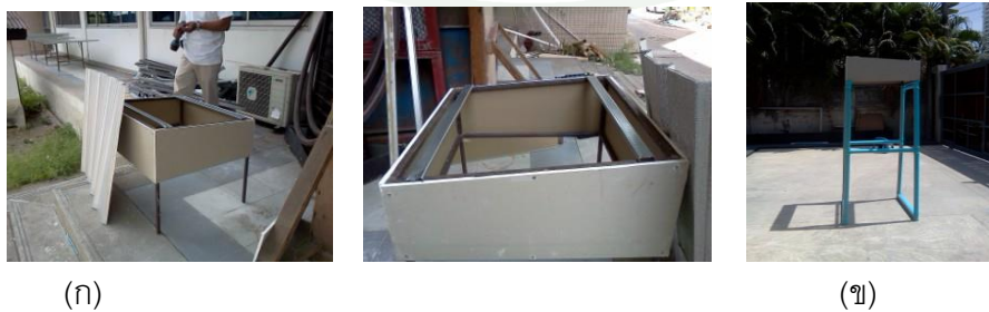
ภาพที่ 28 การประกอบกล่องทดลอง(ก)ประกอบกล่องทดลองและชุดรองรับ(ข)กล่องทดสอบ
