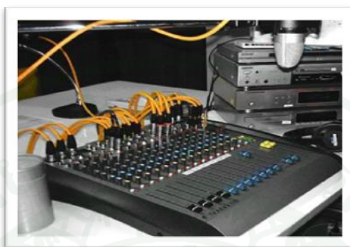
ภาพที่ 9 แสดงเครื่องควบคุมเสียงตามสาย ที่มา: กรมการทหารสื่อสาร (2555)
