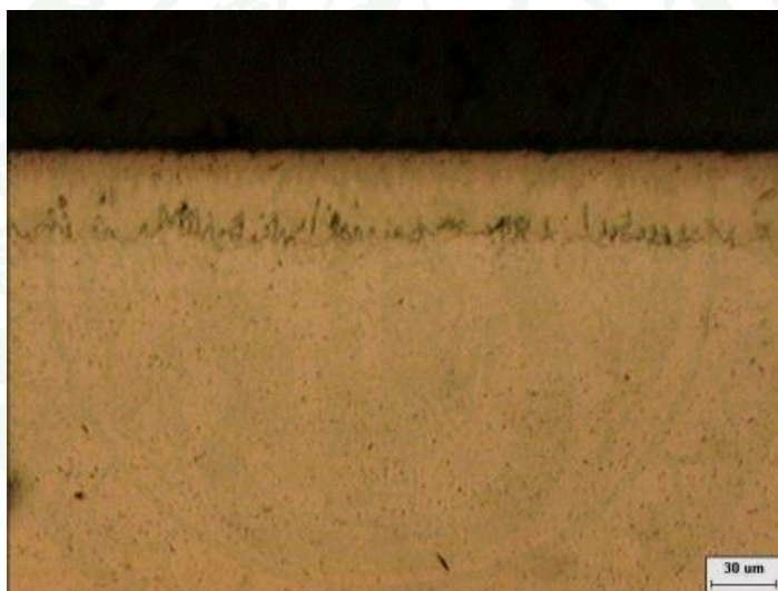
ภาพที่ 42 โครงสร้างจุลภาคของชั้นเคลือบเหล็กอบโร้ดของชิ้นงานที่ผ่านกระบวนการเผ็คอบโร้ดแบบให้ไฟฟ้ากระแสตรงที่อุณหภูมิ 850°C เป็นเวลา 6 ชั่วโมง ที่ระยะห่างระหว่างขั้วอิเล็กโทรด 15 มิลลิเมตร
