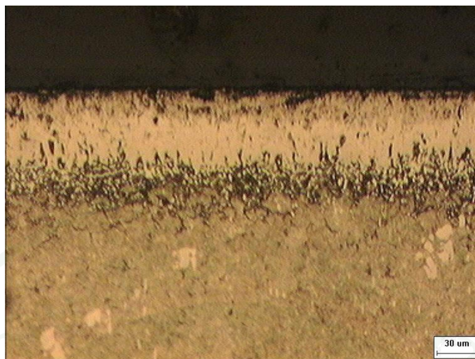
ภาพที่ 28 ภาพโครงสร้างจุลภาคของ เหล็กกล้าเครื่องมือทำงานเย็น AISI D2 ที่ผ่านกระบวนการบอโรไดมิงแบบแพ็คโดยไม่ให้ไฟฟ้ากระแสตรง ที่อุณหภูมิ 900 องศาเซลเซียส เป็นเวลา 6 ชั่วโมง
