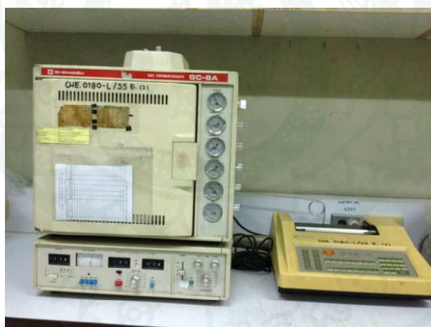
ภาพที่ 10 เครื่องก๊าซโครมาโทกราฟ รุ่น Shimadzu GC-8A ประกอบด้วยดีเทคเตอร์ชนิด FID
