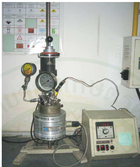
ภาพที่ 5 ชุดเครื่องปฏิกรณ์ไฮโดรเทอร์มัลพร้อมเครื่องควบคุมอุณหภูมิและความเร็วรอบ
