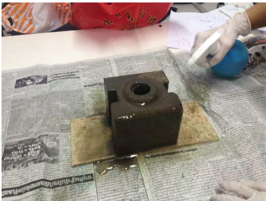
ภาพที่ 22 การผสมอัตราส่วนสาร \text{Na}_2\text{SiO}_3 : \text{NaOH} เท่ากับ 1 ให้ทั่วบล็อกประสานอิโพลีเมอร์
