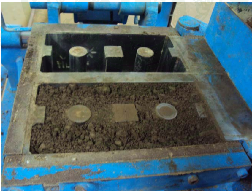
ภาพที่ 21 ขั้นตอนการอัดขึ้นรูปบล็อกประสานจีโอโพลิเมอร์
