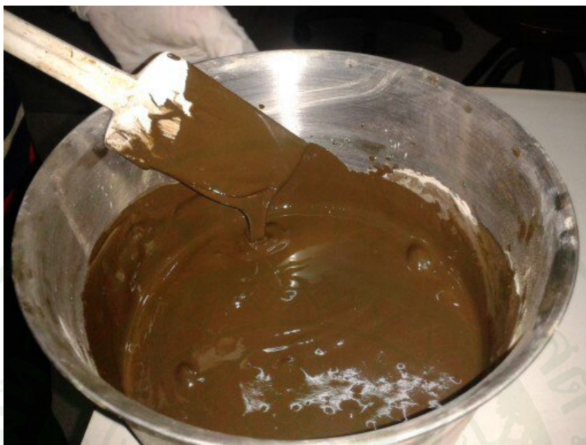
ภาพที่ 15 ขั้นตอนการผสมตะกอนดินในจีโอโพลิเมอร์
