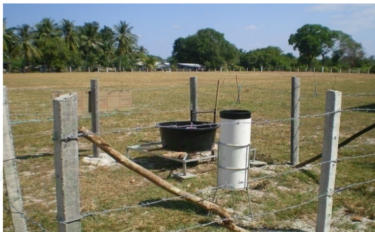
ภาพที่ 3 สถานีติดตั้ง และตรวจวัดปริมาณน้ำฝน การระเหยน้ำ และอุณหภูมิอากาศ ของเกาะสุกร
