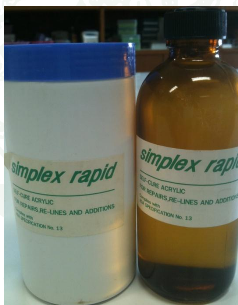
ภาพที่ 1 โพลีเมทิลเมทาไครเลต (Polymethylmethacrylate, PMMA) และสารละลายโมโนเมอร์ (Monomer)(Acrylic Simplex rapid, Kemdent)
