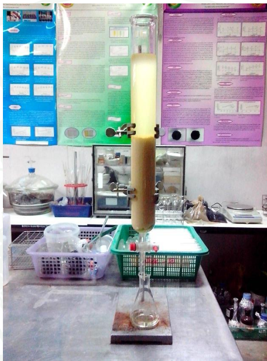
ภาพที่ 22 ลักษณะคอลัมน์ที่ใช้ศึกษาประสิทธิภาพการกำจัดโพแทสเซียมไอออนในน้ำมันไบโอดีเซลดิบด้วยเรซินแลกเปลี่ยนแคตไอออน
