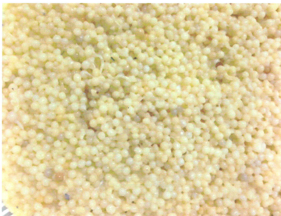
รูปที่ 9 เม็ดปุ๋ยสูตร 15-0-0 ที่เตรียมขึ้นใหม่
