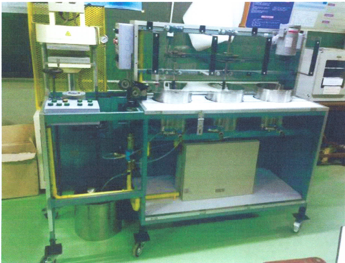
รูปที่ 2 เครื่องต้นแบบในการผลิตปุ๋ยชนิดควบคุมการปลดปล่อย (ด้านหน้า)
