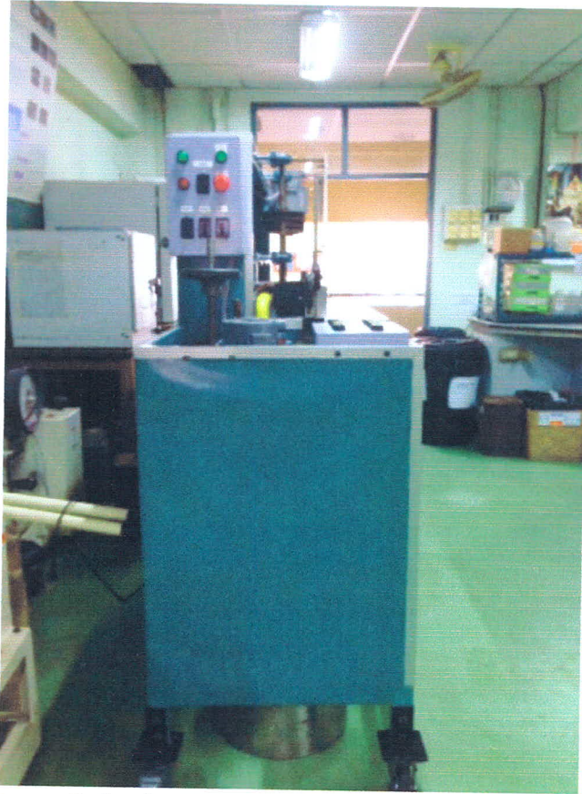
รูปที่ 3 เครื่องต้นแบบในการผลิตปุ๋ยชนิดควบคุมการปลดปล่อย (ด้านข้าง-ซ้าย)
