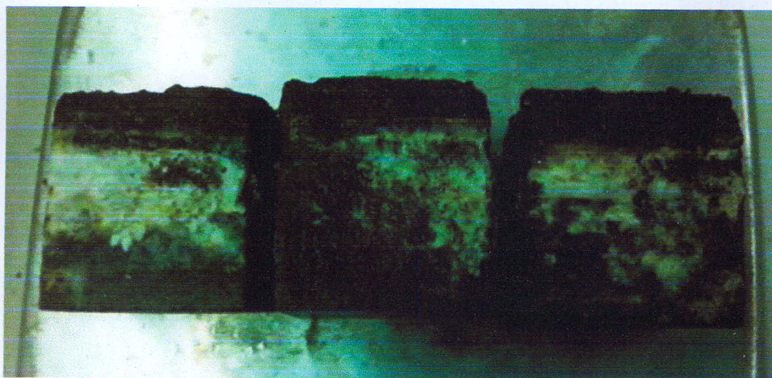
รูปที่ 4.14 ผิวของวัสดุจีโอโพลิเมอร์เมื่อแช่กรด 5% HCl เป็นเวลา 6 เดือน
