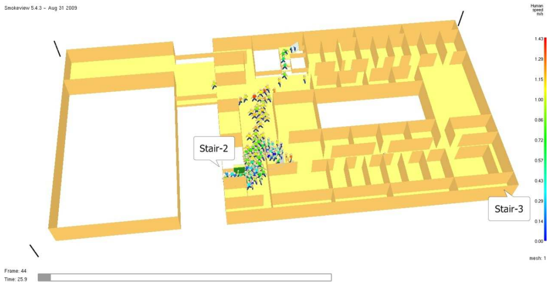
ภาพที่ 36 แสดงการเลือกใช้บันไดทางออกบริเวณชั้น 5 กรณีไม่มี Stair-3 ของโปรแกรม PyroSim
