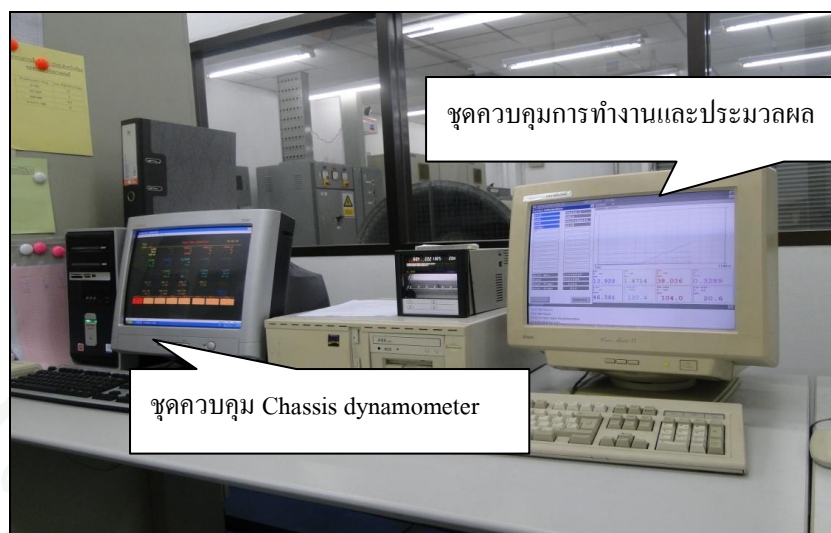
ภาพที่ 13 ระบบควบคุมการทำงานและประมวลผลข้อมูลการทดสอบสารมลพิษรถจักรยานยนต์
