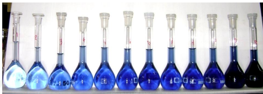
ภาพที่ 6 สารละลายมาตรฐานฟอสเฟตความเข้มข้น 1-10 มิลลิกรัมต่อลิตร
