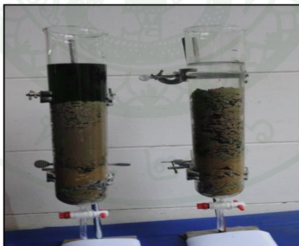
ภาพที่ 23 คอลัมน์บรรจุชั้นวัสดุเพาะปลูกโดยเรียงลำดับจากชั้นกรวด, ทรายหยาบ, ทรายละเอียดและส่วนผสมของถ่านเปลือกกะลามะคาเดเมียที่ปรับสภาพด้วยสารละลายโซเดียมคลอไรด์กับดินเหนียวปนทราย
