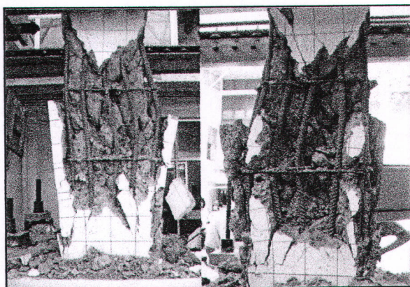
(ก) รูปการทดสอบหลังการวิบัติของเสาตัวอย่างทดสอบ S1
