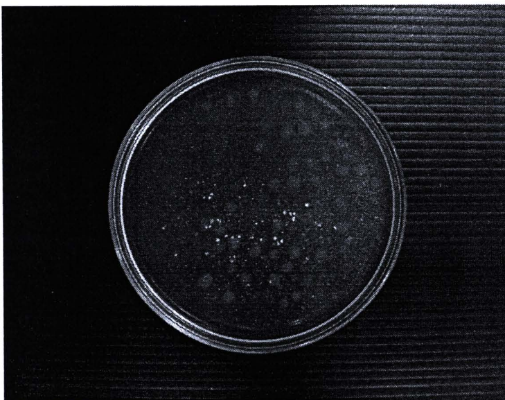
รูปที่ 4.20 ลักษณะเม็ดเคลือบเพคติน (6%) ที่ผ่านการทดสอบใน (ก) 0.1 N. HCl : pH 1.2 และตามด้วย (ข) PBS : pH 6.8 นาน 2 ชั่วโมง
