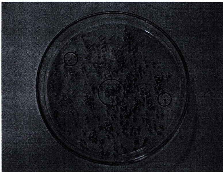
รูปที่ 4.14 รูปร่างเล็ก ๆ (แสดงในวงกลม) ที่ตรวจพบได้ด้วยตาเปล่าบนผิวของแกรนูลเคลือบฟิล์ม
